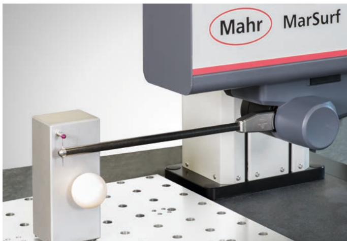
Medição com ponta dupla no padrão de calibração
