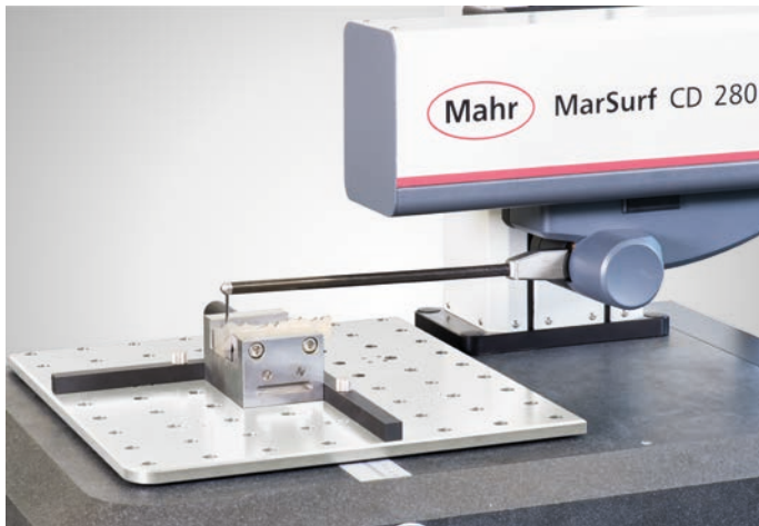
Medição com apalpador padrão CPG A 36-350-25 / 12 ° no padrão de teste
