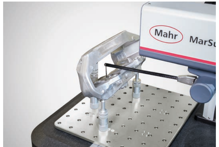
Medição com ponta longa CPG A 62-350-25 / 19 ° permite acesso a locais de medição profundos
