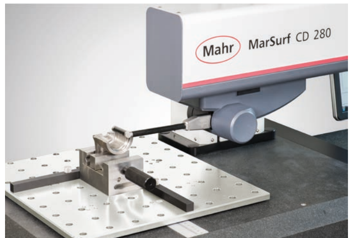
Medição com ponta transversal CPG A 33-210-25 / 30 q50
